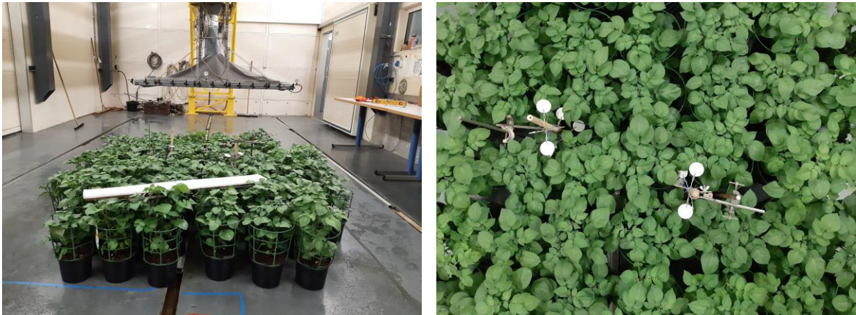
Figuur 1 Aardappelplanten in de spuitbaan (links) met afgiftedoeek. Boven-aanzicht met twee wisselplanten in het midden en statieven met rondfilterpapier (rechts).
