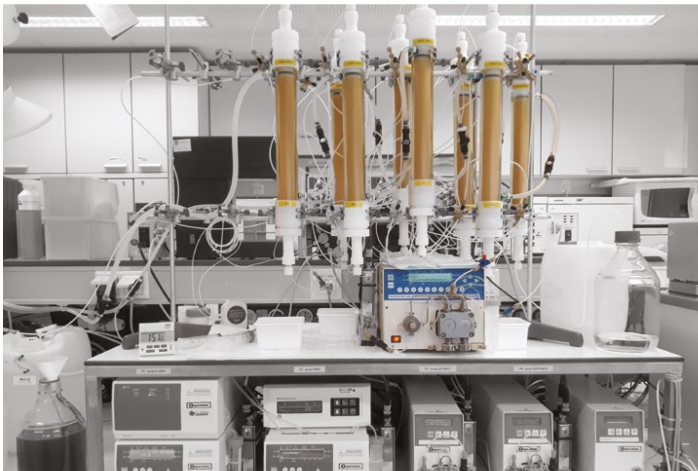
De proefopstelling waarmee Floor Boon en collega's fruitsuikers en -zuren uit sinaasappelsap halen • Foto Wageningen Food & Biobased Research
