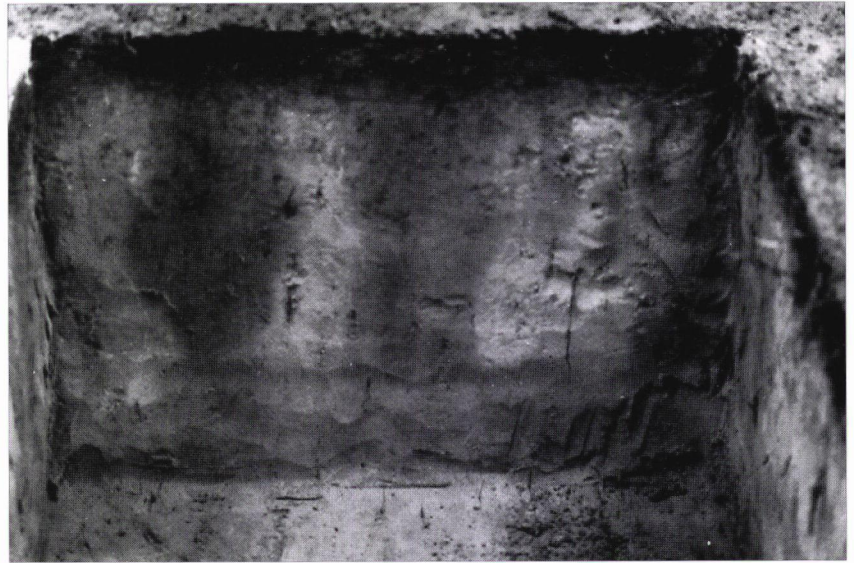
Figuur 3: Homogeen natte laag (donker) onder een waterafstotende laag met preferente stroombanen (donker) en tussenliggende droge zones (licht). 7
