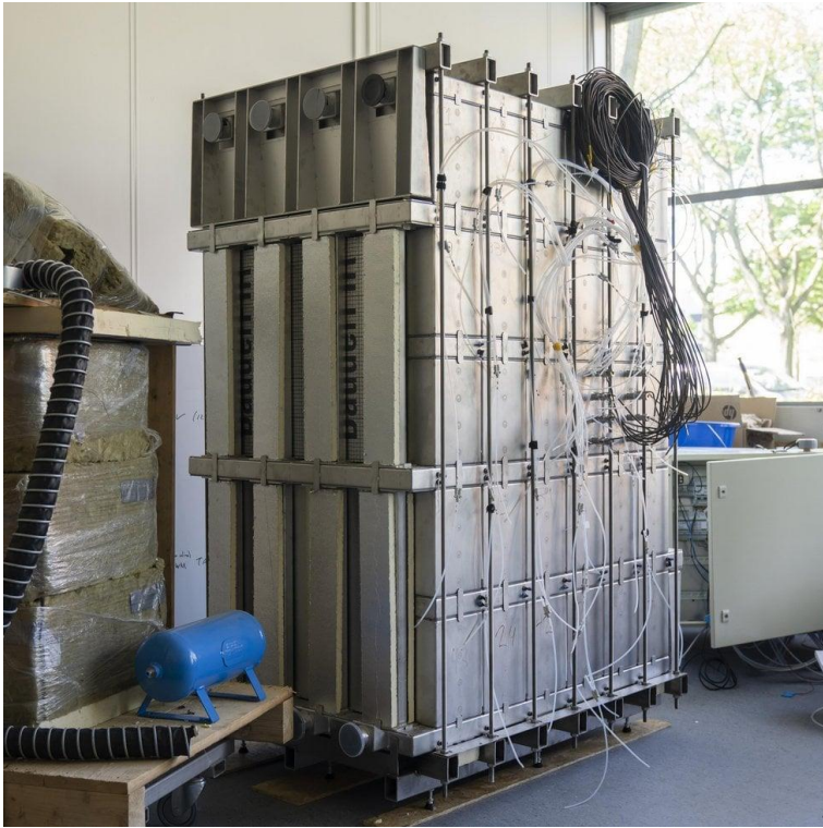
Figuur 3.1 Prototype van de modulaire warmte batterij van Cellcius bestaande uit 30 'kluisjes' die gezamenlijk een opslagcapaciteit bezitten van 200 kWh thermisch [3].
