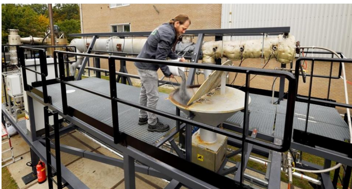
Figuur 3.3 Links: een werknemer giet de ijzerbrandstof in de invoer voor de verbrandingskamer bij de Swinkels family brouwerij Bavaria ter demonstratie van de ijzer verbrandingstechnologie [15]; Rechts: het ontwerp van de ijzer verbrander en mogelijke toepassingen [16].
