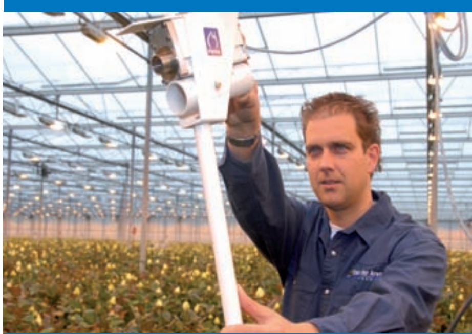
Richard van der Lans: "Met behulp van een infraroodcamera registreren we de kas- en de bladtemperatuur. De klimaatcomputer weet dus wanneer er een stresssituatie nadert."
