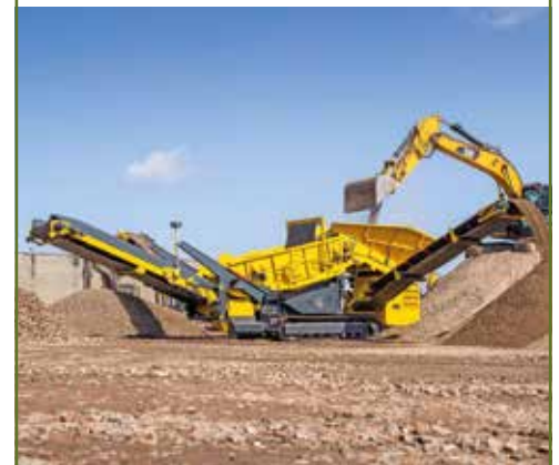
Er hoeven slechts zes lagers te worden gesmeerd. Dat vergt weinig tijd, maar de kans op overslaan of fouten is altijd aanwezig. Eens in de 500 uur tegelijkertijd met het periodiek onderhoud goed doorsmeren is dan veiliger.
