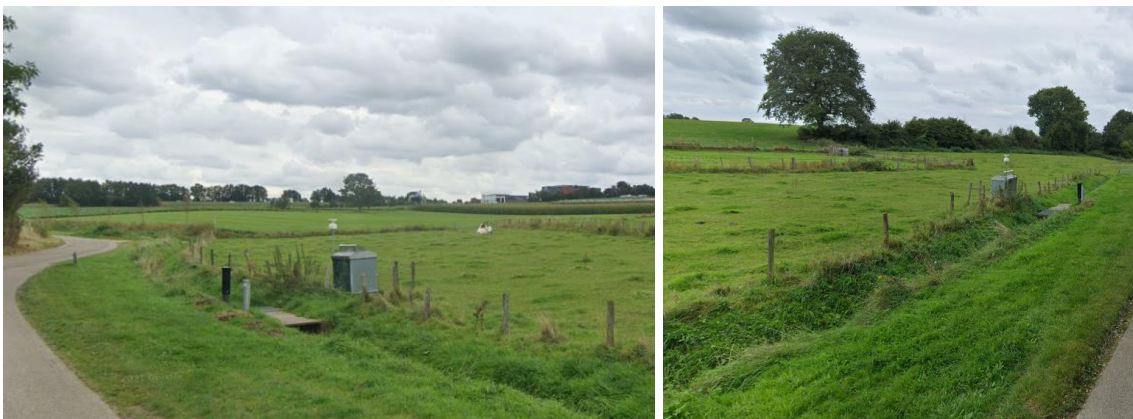
Figuur 5 Meetopstelling voor bemonstering van maaiveldafvoer en sediment aan Sickendaelweg te Catsop (foto: Google Street View, sept. 2021): a) zicht stroomopwaarts richting zuidoost, b) zicht stroomafwaarts richting noordwest.
