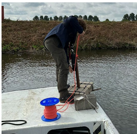
Figuur 3.2 Plaatsing van akoestische ontvanger aan stalen frame
