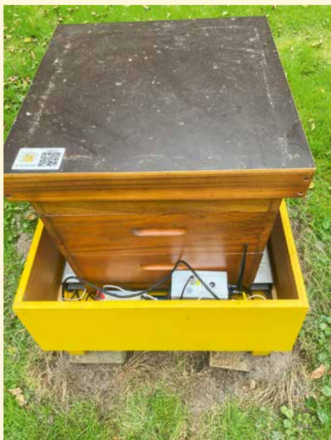
Kast met de sensoren die het gewicht (honing dracht en gebruik), het aantal uitgaande en binnenkomende bijen en de broed temperatuur meten.
