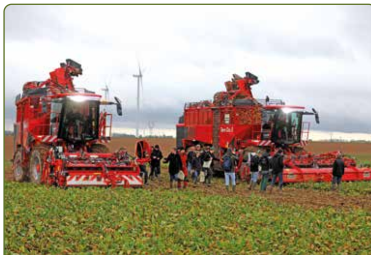
Holmer toonde de Terra Dos 5-30 met twee assen en zes rijen en de Terra Dos 5-40 twaalfrijer. De fabrikant heeft zijn werkverlichting aangepast, voor een beter comfort voor de chauffeur.
