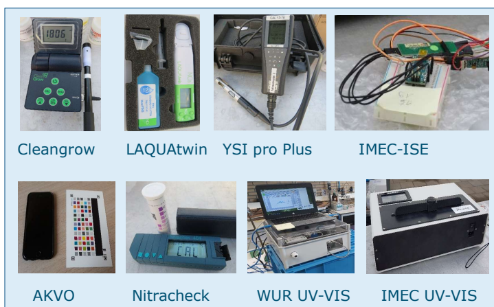
Figuur 1. Overzicht van 8 geschikte nitraatmeters.
