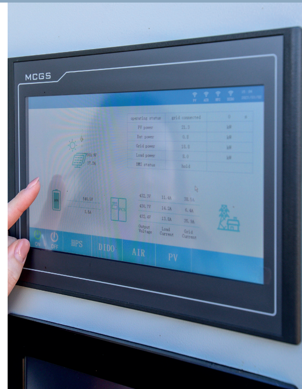
De nieuwe batterijen bestuderen zelf de elektriciteitsmarktprijs. Ze laden op of injecteren stroom op het net als dat financieel het meest rendabel is
