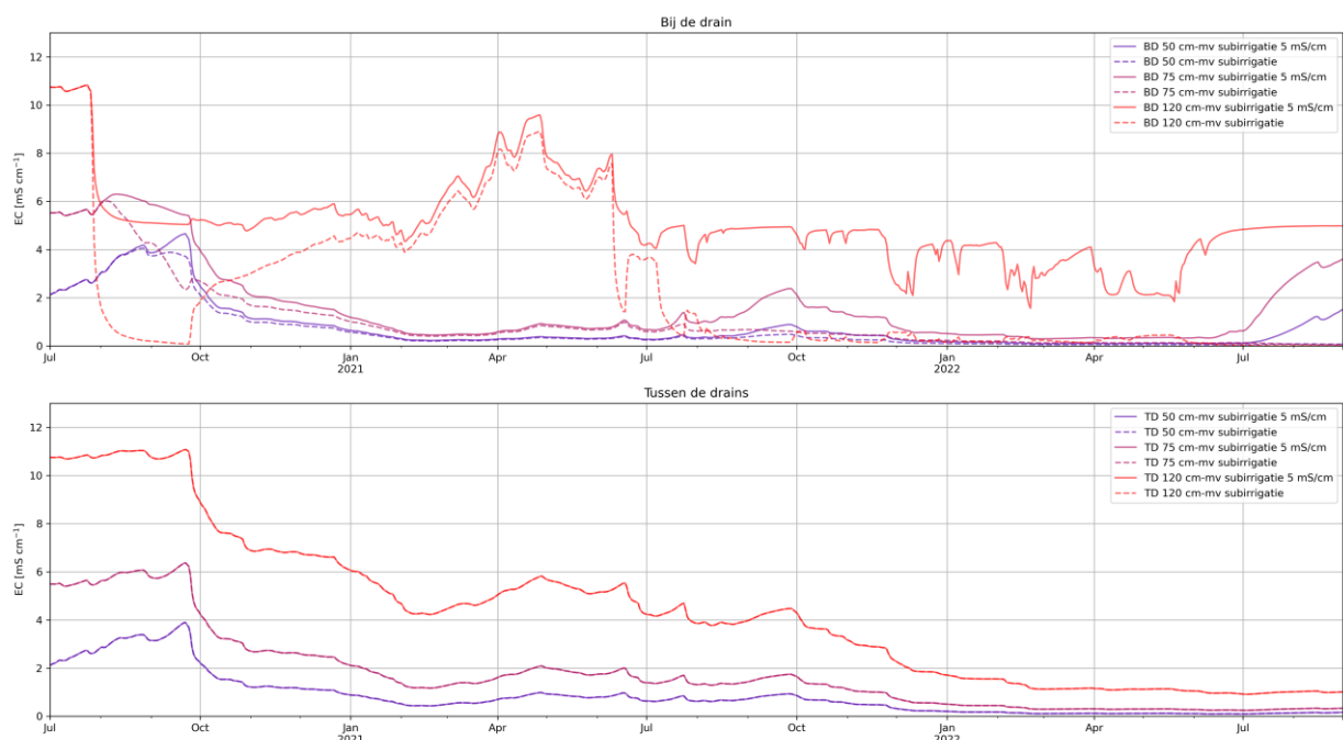
Figuur 45 Boven: verschil in gesimuleerde zoutconcentraties bij de drain op verschillende dieptes tussen de huidige situatie (subirrigatie) en het scenario subirrigatie met een zoutconcentratie van 5 mS/cm. Onder: idem, maar tussen de drains.
