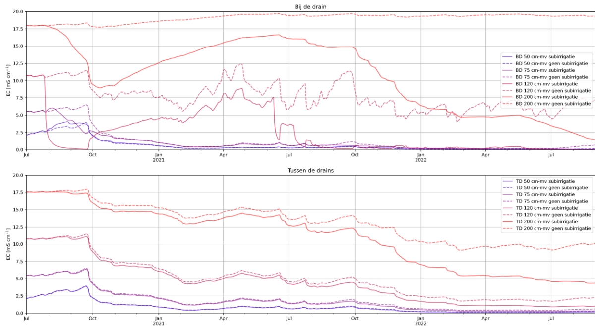
Figuur 38 Boven: verschil in gesimuleerde zoutconcentraties bij de drain op verschillende dieptes tussen de huidige situatie (subirrigatie) en het scenario zonder subirrigatie. Onder: idem, maar tussen de drains.
