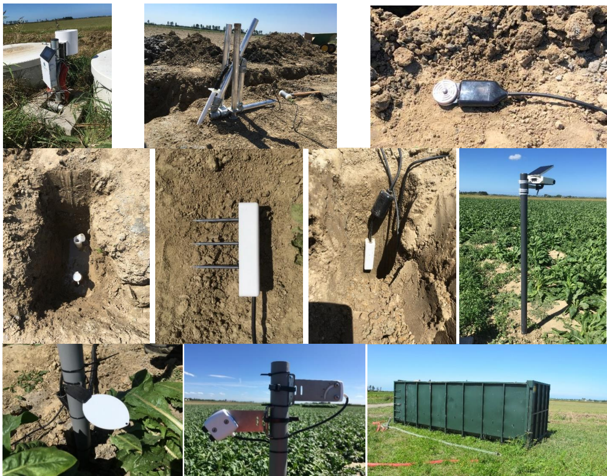
Figuur 13 Meetapparatuur aanwezig op het proefblok. Logger kast met regenmeter (linksboven), TEROS-32 tensiometer (midden boven), drukhoogte sensor TEROS-21 (rechtsboven), peilbuizen met CTD-10 drukopnemers (midden links), TEROS-12 bodemvochtsensor (midden), time lapse camera gewasgroei (midden rechts), leaf wetness sensor PHYTOS 31 (linksonder), Spectral Reflectance Sensor (SRS) (midden onder) en het voorraadreservoir ter plekke van de kavel (rechtsonder).
