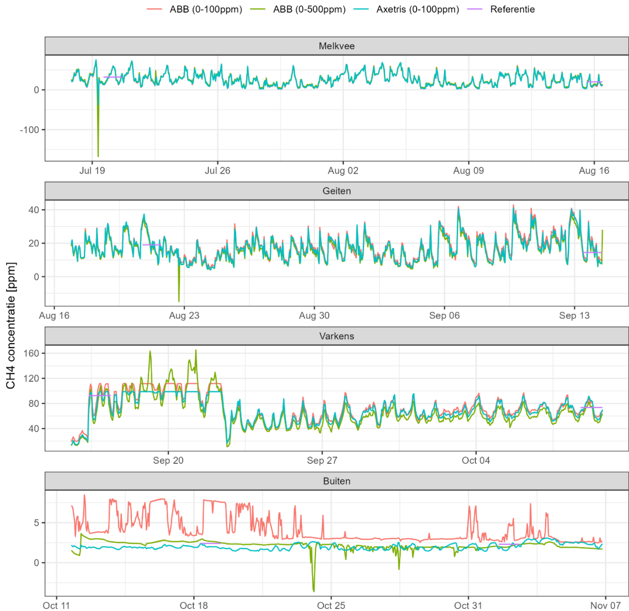
Figuur B2.1 Gemeten concentratie tijdens praktijktest in de periode van juli 2021 tot november 2021 voor de sensoren ABB (0-100 ppm), ABB (0-500 ppm), Axetris (0-100 ppm) en de standaard referentiemethode.
