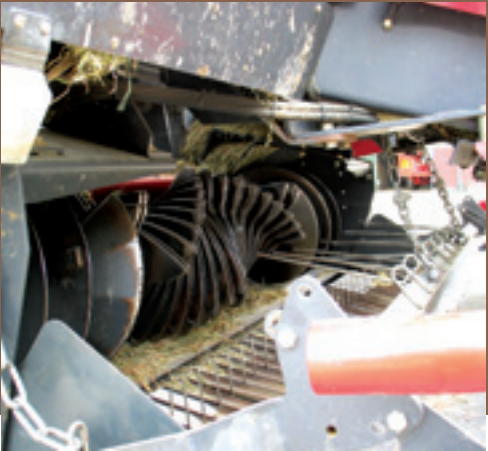
Het OptiCut-snijsysteem. Wanneer een gewas gesneden moet worden kan de bestuurder ervoor kiezen om alle 23 messen te gebruiken, of hij kan kiezen voor twee alternatieve groepen van 11 of 12 messen.
