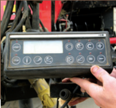
AutoForm controleert, regelt en stuurt waar nodig volautomatisch de vooraf ingestelde persdruk. Het display van de AutoForm toont continu o.a. de volgende informatie: hydraulische druk in het perssysteem, belastingsniveau in de machine tijdens het persen en informatie over het pakvormingsproces.
