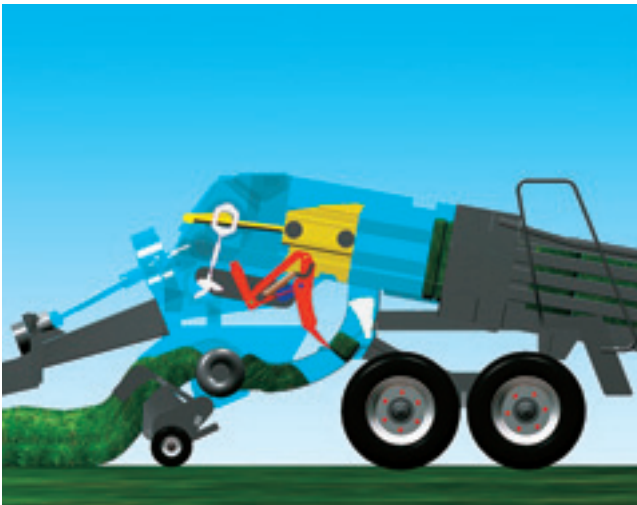
Met ‘Power Density’ wordt een enkele invoervork gebruikt om het gewas voor te verdichten.
