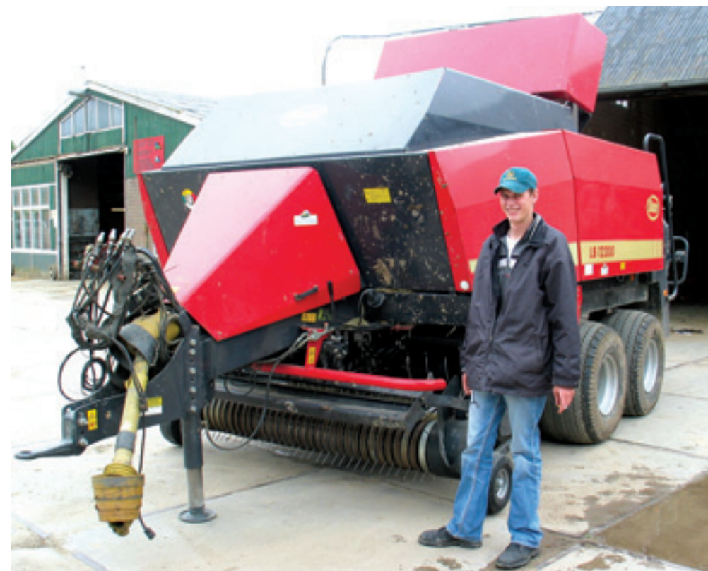
Toon Peters naast de LB 12200. De constructie van de hoog-laag-trekdisel garandeert voldoende ruimte tussen dissel en zwad in elke denkbare positie.
