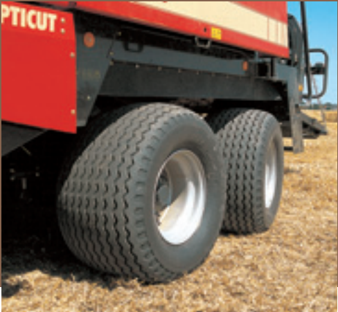
De tandmassen zijn onafhankelijk geveerd en de achterste as is gestuurd. Naar keuze kan de pers uitgerust worden met extra grote lagedrukbanden.
