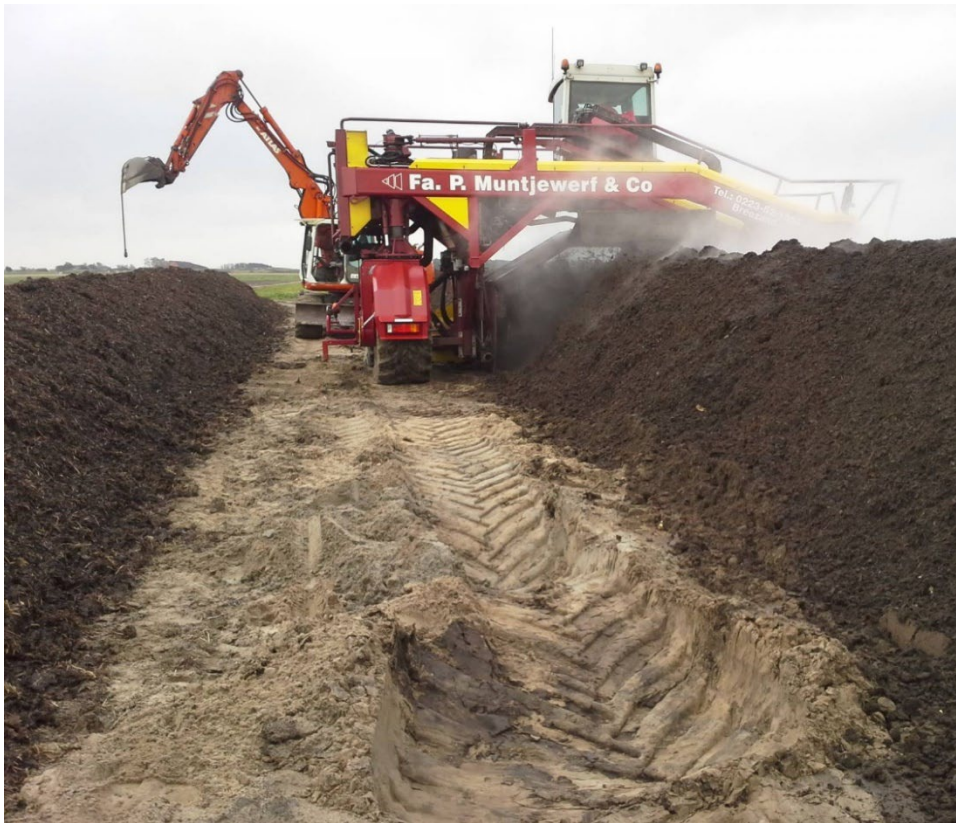
Figuur 15 Composteerma­chine van Muntjewerf in actie om de composthoop te bewerken en de compost te mengen voor een beter eindproduct (Muntjewerf 2016).
