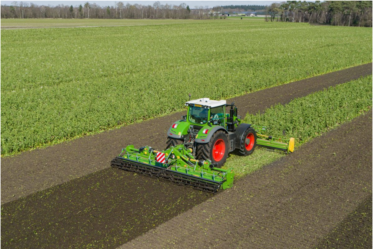
Figuur 16 Het mechanisch scheuren van grasland d.m.v. een klepelmaaier en frees combinatie.
