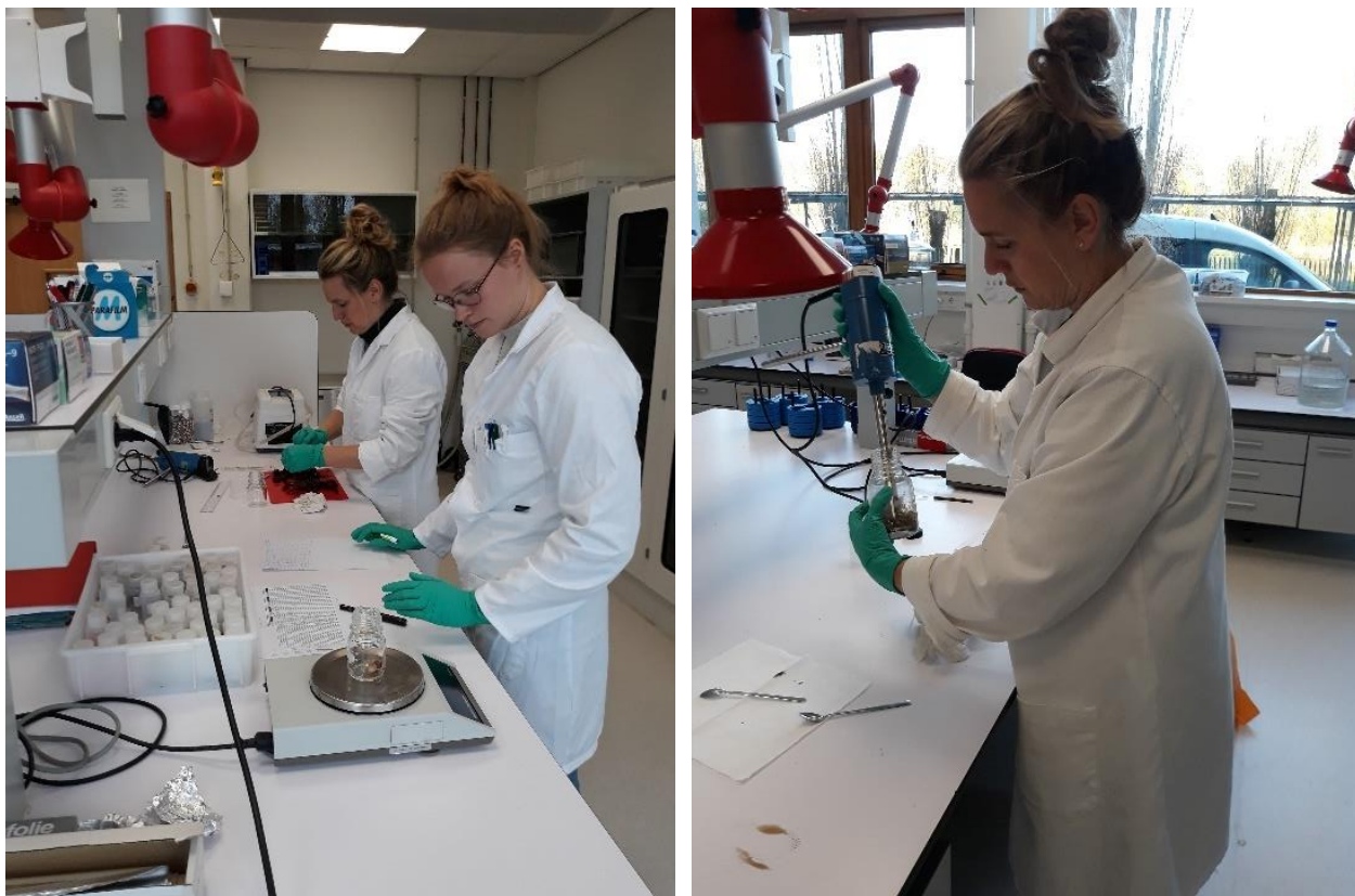
Figuur 12 Impressie van de opwerking van de gevangen rivierkreeften. Links: het opdelen in kop- en staartmonsters. Rechts: het mengen van het materiaal met de Ultra-TURRAX.
