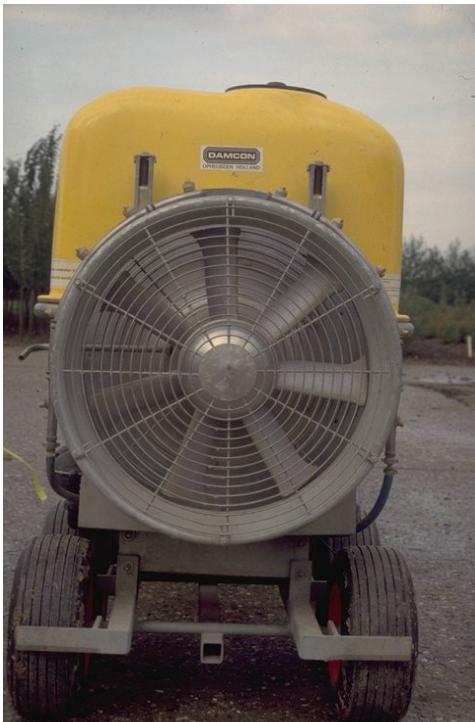
Figuur a. De standaardspuit. Figure a. The conventional axial fan sprayer.
