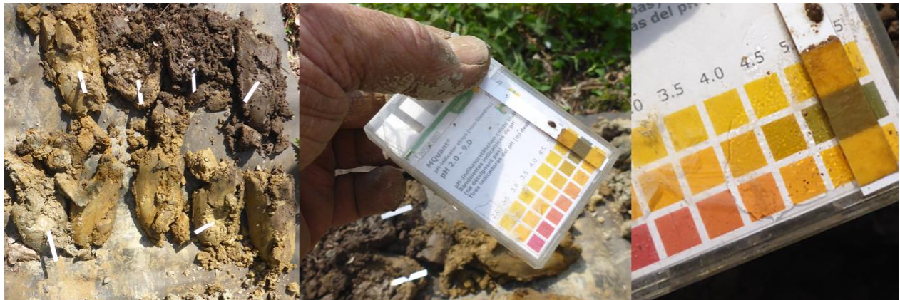
Figuur 1.1 Veldbepaling van pH met indicatorstrookjes. Deze worden in de grond gestoken waarna de grond nat gemaakt wordt met demi-water. Na enige tijd kan de pH worden afgelezen aan de verkleuring. De schaal kent stappen van een halve pH-eenheid. Tussentijdse waarden kunnen op 0.1 eenheid geschat worden. De gebruikte strookjes hebben een bereik van pH = 2.0 tot 9.0.
