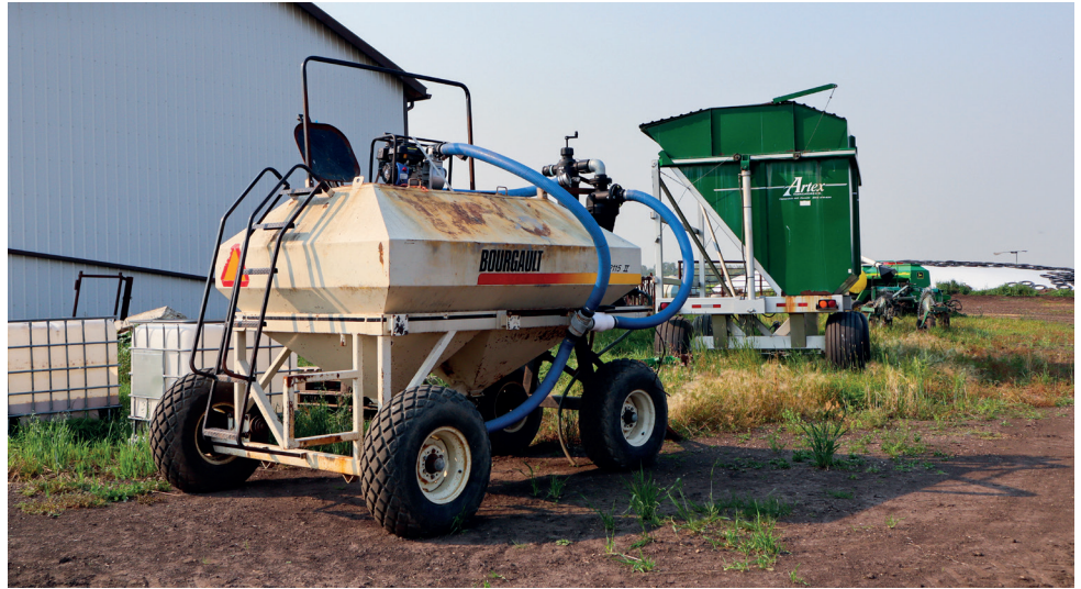
Voordat Gagelmans de vloeibare meststof toedient, mengt en filtert hij de compost met melasse, visafval en water in een mengtank
