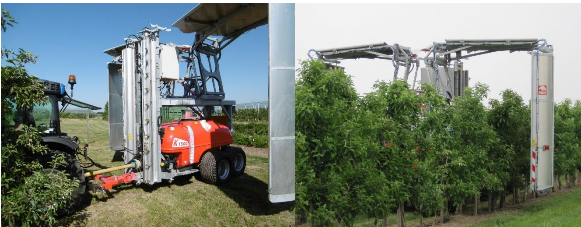
Figuur 2.1 Wanner NTR 20 2-rijen dwarsstroomspuit met reflectieschermen en luchtregelingsysteem.
