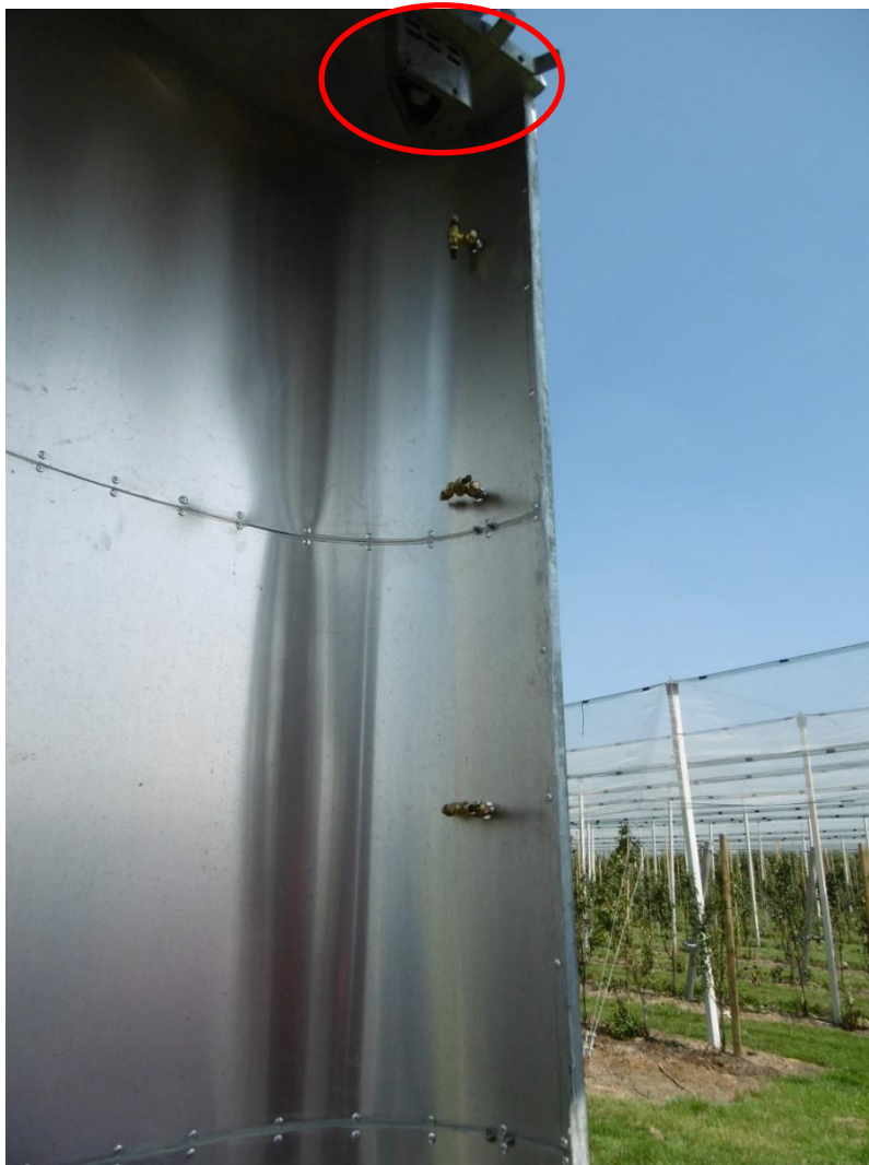
Figuur 2.3 Doppen aan binnenzijde van het reflectiescherm (niet de ID 90-01 C doppen welke in dit onderzoek zijn gebruikt), met bovenin de anemometer (rode cirkel) waarmee de luchtsnelheid wordt gemeten.
