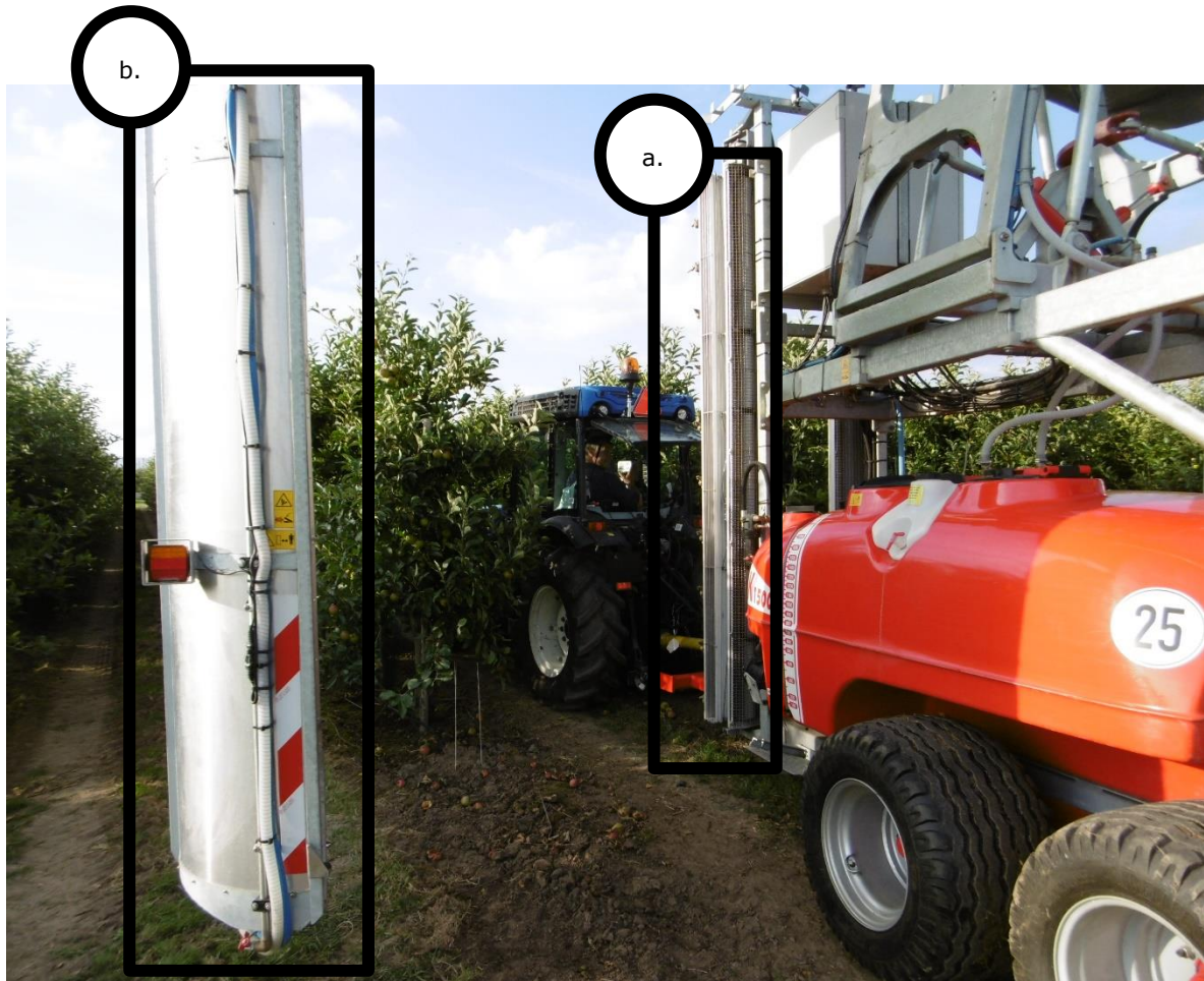
Figuur 2.6 De lucht en vloeistof wordt vanaf de tangentialventilatoren met daarvoor de doppen (a.) naar de bomen geblazen. De lucht en vloeistof die door de bomen komt wordt teruggebogen door de reflectieschermen (b.), hier wordt extra vloeistof aan toegevoegd bij het uiteinde van het reflectiescherm (figuur 2.3). Vloeistof die neerslaat in het reflectiescherm wordt opgevangen en opnieuw gebruikt.
