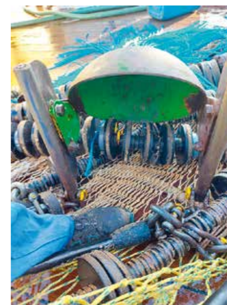
Twister met ophangstelsel zoals gebruikt tijdens het innovatietraject binnen 'tuiginnovatie tongvisserij' op de SCH 63.
