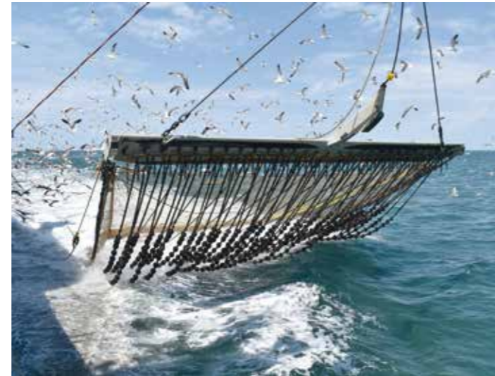
Bakboord- en stuurboordtuig tijdens de vergelijkingsreis van de TX 36. Bakboord: rubberstrengen-twistertuig met waterspraywing. Stuurboord: wekkertuig met tongflap met waterspraywing.
