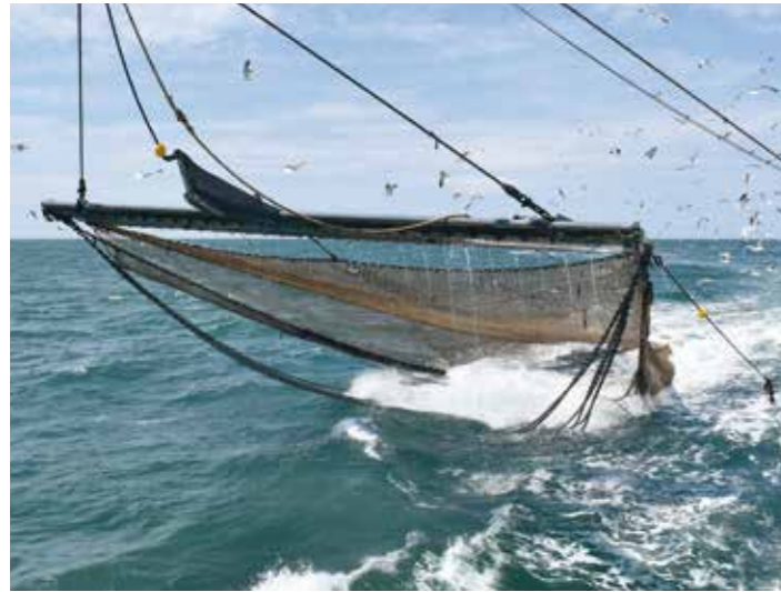
Bakboord- en stuurboordtuig tijdens de vergelijkingsreis van de TX 36. Bakboord: rubberstrengen-twistertuig met waterspraywing. Stuurboord: wekkertuig met tongflap met waterspraywing.
