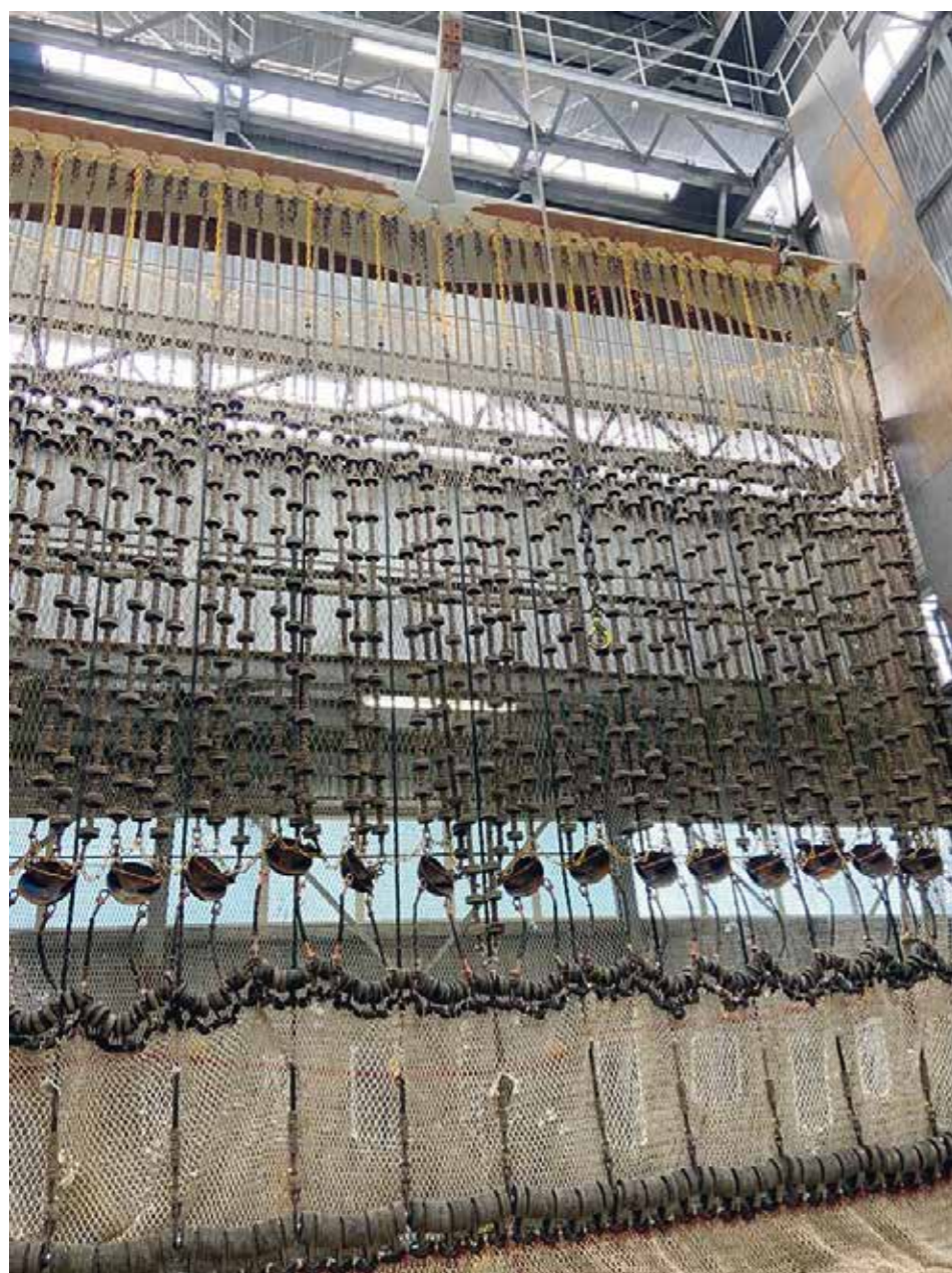
Rubberstrengen-twistertuig bevestigd op een waterspraywing zoals getest op de TX 36.
