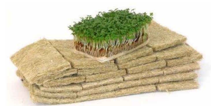
Figuur 22 Vernaalde mat op basis van hennepvezel als groeimedium voor de tuinbouw. Foto HempFlax.
