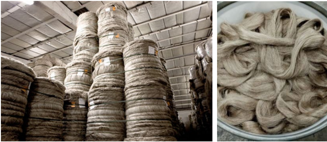
Figuur 30 Balen van hekelband (bumps, links); gekamd hekelband (rechts). Foto HOGENT.
