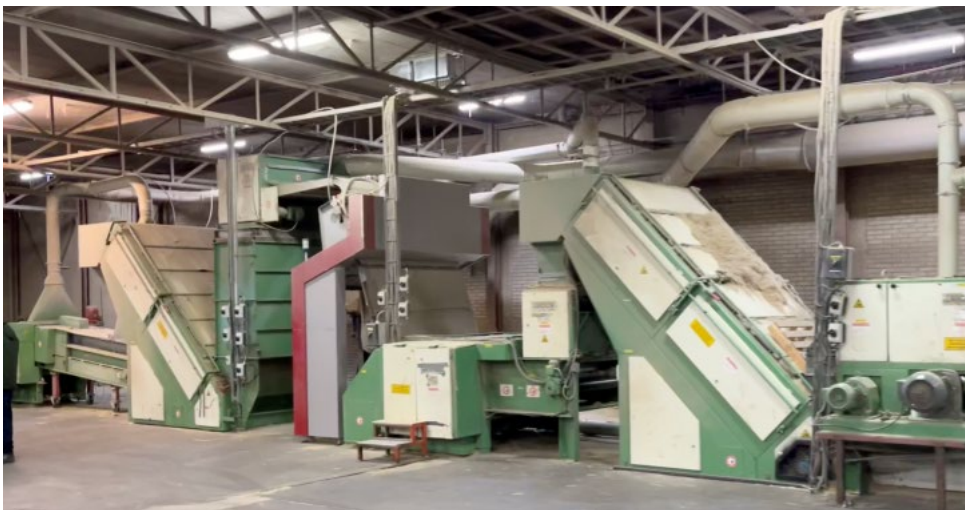
Figuur 18 Verfijnen en schoon maken van hennepvezels. Foto HempFlax.
