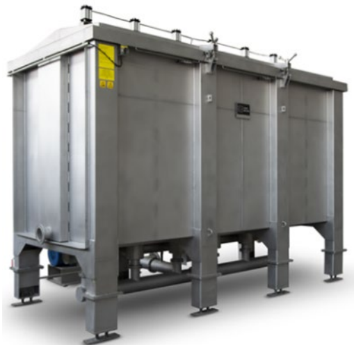
Figuur 34 Machine voor het afkoken en bleken van passageband. Foto Loris Bellini.
