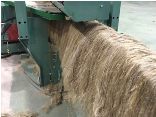
Figuur 28 Gezwingelde lange vezels verlaten de zwingellijn. Foto HOGENT.
