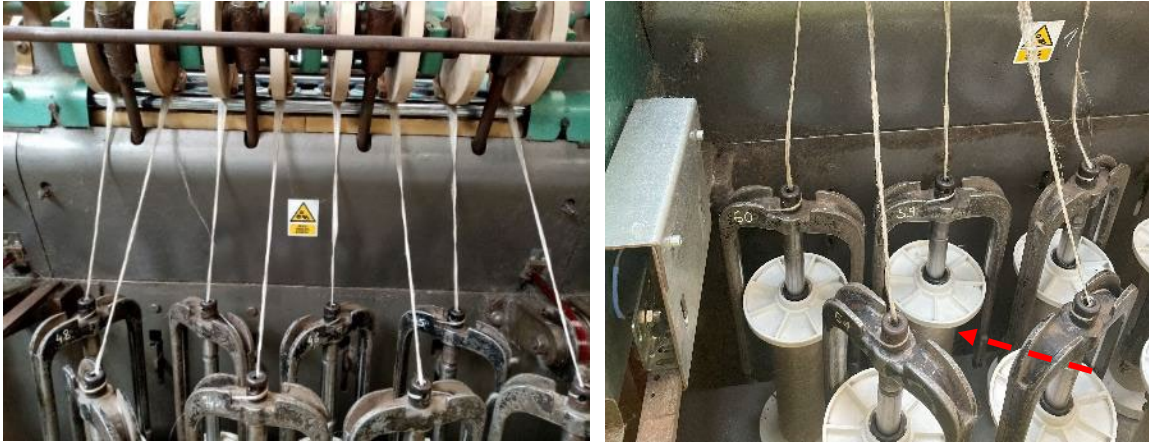
Figuur 33 Spilbank voor het verwerken van passageband tot voorgaren (wiek). Foto's HOGENT.
