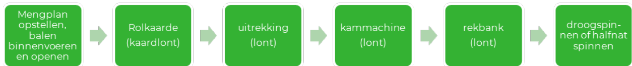
Figuur 38 Processtappen van zwingellokken (droogspinnen) en hekelsnuit (halfnat spinnen) tot het spinnen tot 'werk-garen'.
