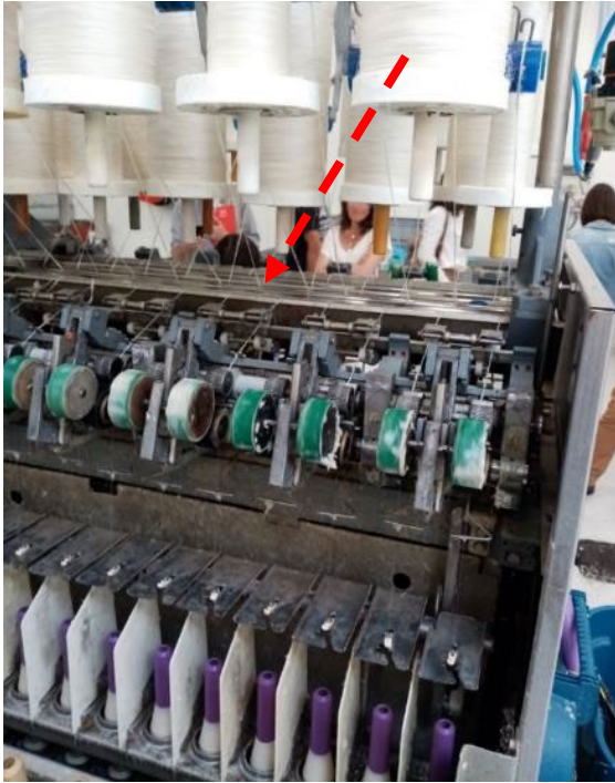
Figuur 36 Nat ringspinnen van lange gebleekte vezels. De pijl geeft aan waar het garen door het warmwater bad loopt. Foto HOGENT.
