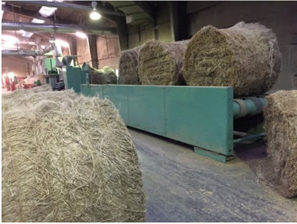
Figuur 26 Aanvoeren van balen aan de zwingellijn: breken + zwingelen. Foto HOGENT.
