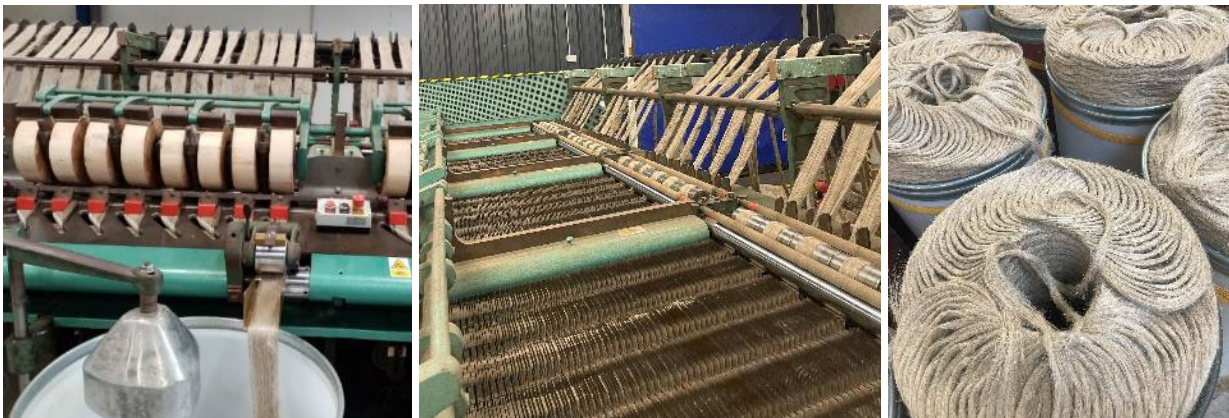
Figuur 32 Verstreken en dubbelen van hekelband tot 'passageband' (links); bovenaanzicht (midden); passageband in ton (rechts). Foto's HOGENT.
