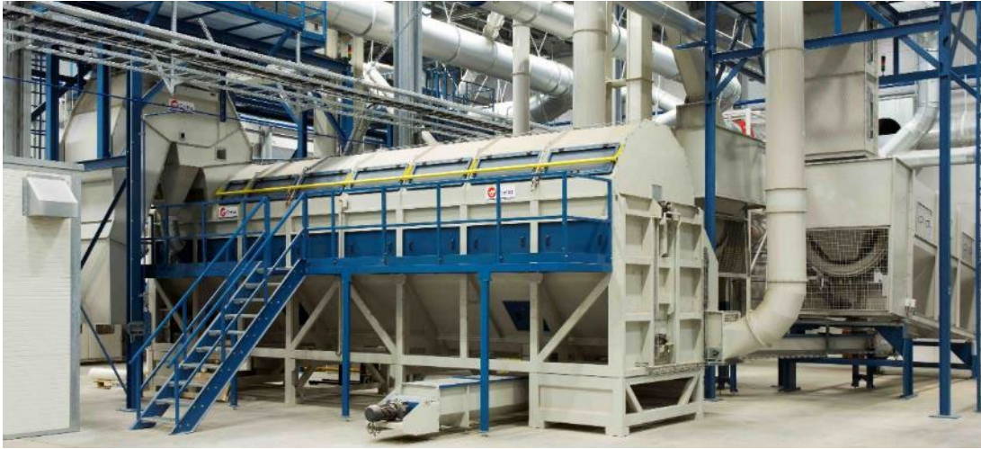
Figuur 17 Duvex zeeftrommel voor scheiden van bastvezels en scheven. Foto Cretes.
