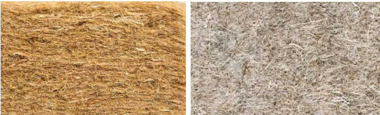
Figuur 20 Hennep gebaseerd vezelmat voor thermische isolatie van gebouwen (links) en voor geluidsisolatie, bijvoorbeeld onder zwevende vloeren (rechts). Foto's Thermo-Hanf.
