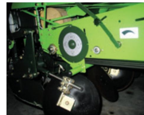
Zijaanzicht van de machine met onder de aanaardschijven. In het midden de schijf voor het instellen van de maat en de handel voor de instelling van het trillen van de snaren.
