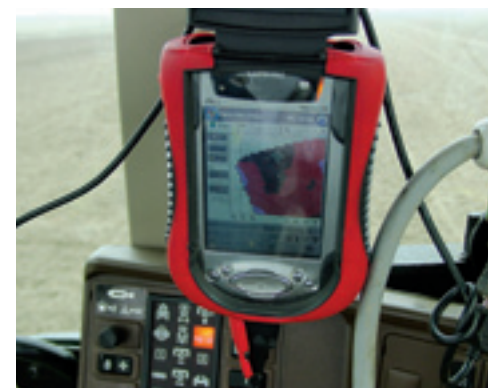
Alle perceel gegevens worden opgeslagen in de pocket pc (rood). Met behulp van het GPS-signaal geeft deze de juiste pootafstand door aan de PM Control.
