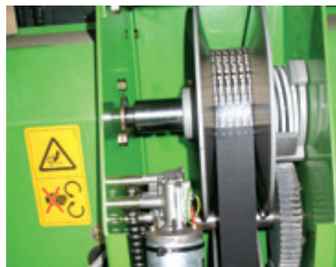
Door middel van de elektronisch bediende variator is de pootafstand traploos te verstellen.
