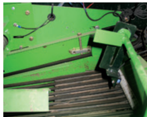
Links op de foto de zogenoemde 'splitter' die er voor zorgt dat er geen aardappelen op de vooruit draaiende snaren vallen. Rechts de sensor die de vulling van het snarenbed in de gaten houdt.
