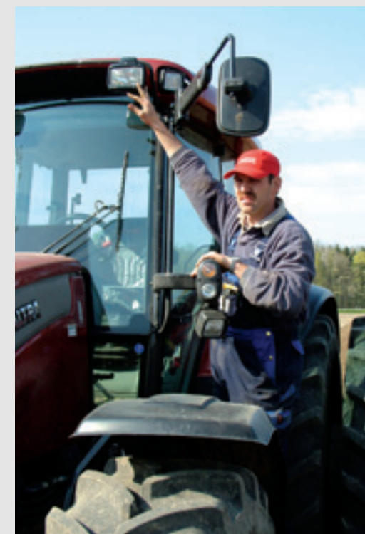
Harold Zondag kocht de Valtra zo compleet mogelijk met uitgebreide hydrauliek en onder andere extra koplampen in de dakrand die voor meer veiligheid bij geheven werktuigen zorgen.
