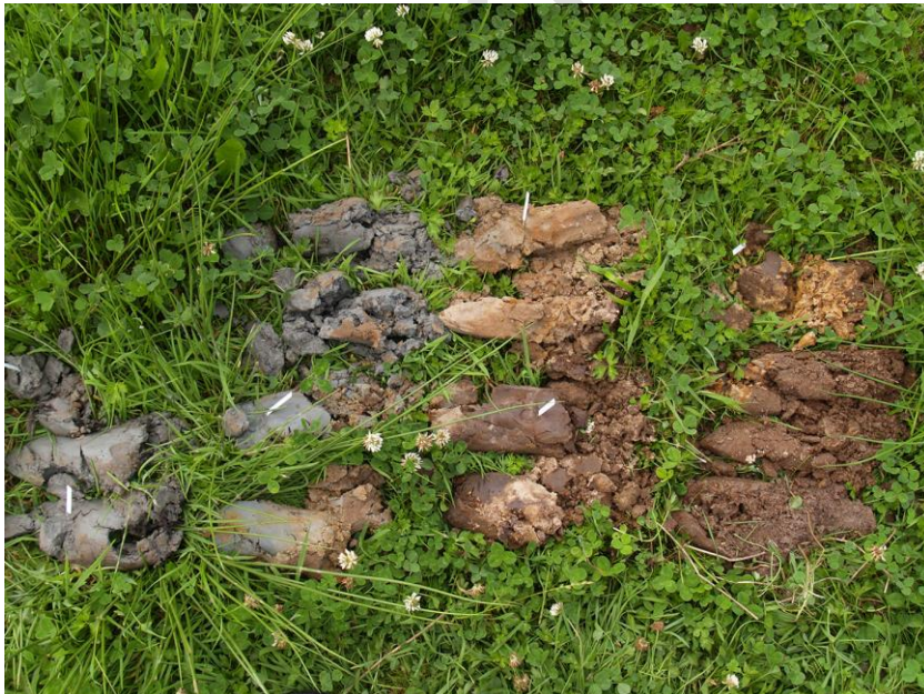
Figuur 7 Veldbepaling van pH met indicatorstrookjes. Deze worden in de grond gestoken waarna de grond nat gemaakt wordt met demi-water.
