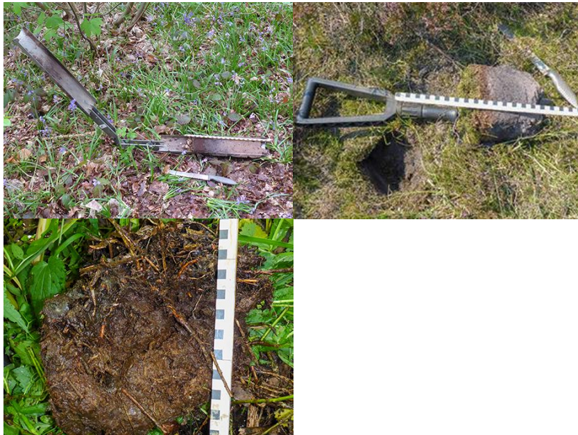
Figuur 5 Het steken van een humusprofiel met een humushapper (links), schep (midden), mes (rechts).
