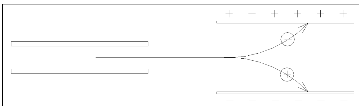
Figuur 11 Scheiding van een positief en negatief geladen deeltje.
