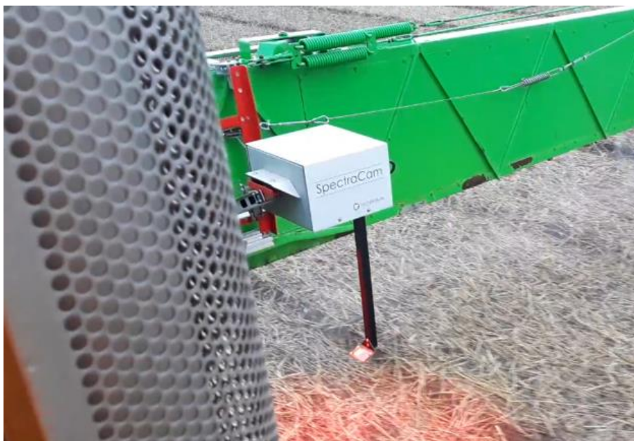
Figuur 1 Spectracam gemonteerd onder de boom van een veldspuit.
