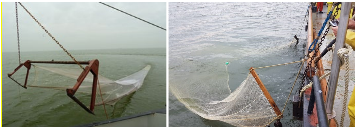
Verhoogde 4-meter boomkor (links) en grote kuil (rechts). Voor netspecificaties zie bijlage 1.
