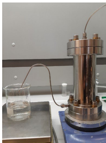
Figuur 3-1 Testopstelling voor batch membraanfiltratie.
