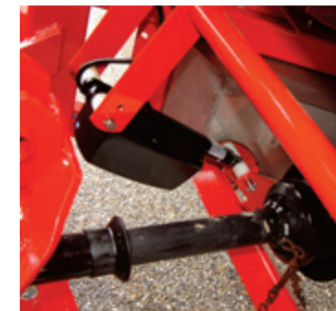
De kleppen worden bediend door een elektrische spindel-motor.
