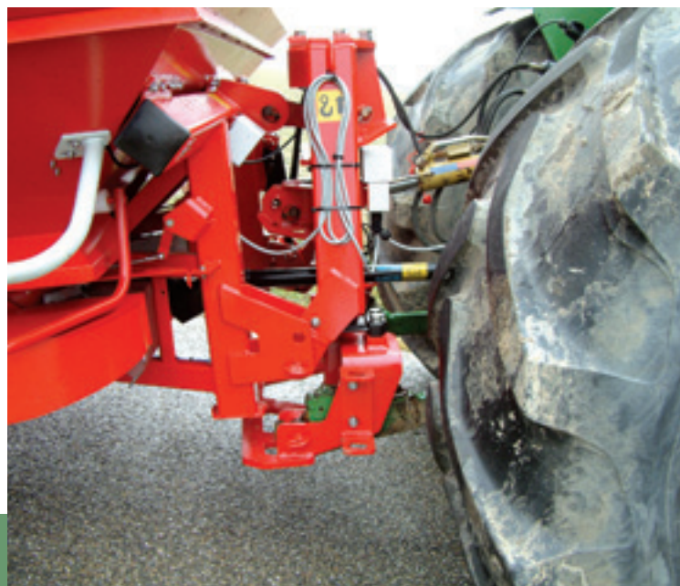
Het aanspanningspunt van de strooier aan de weegbok ligt ongeveer 15 cm hoger dan wanneer je alleen de strooier aan de trekker doet. Met behulp van een hydraulische topstang kan je de strooier achterover laten hellen om hem goed af te kunnen vullen.
