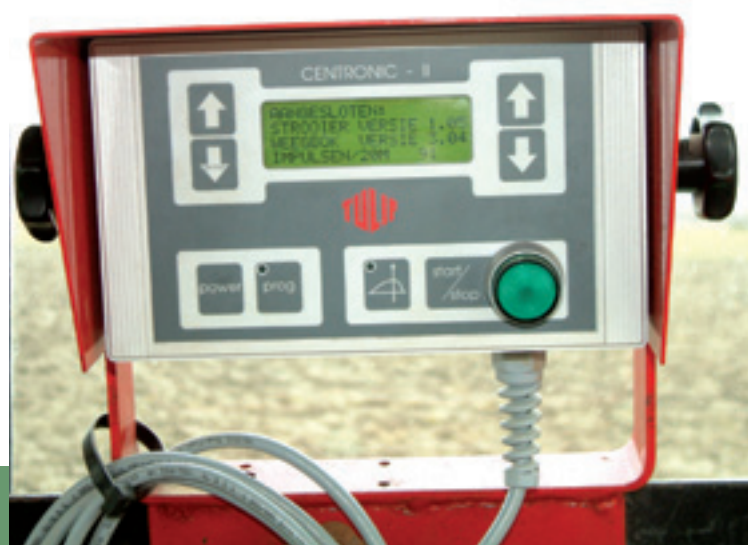
Het display van de strooi-computer is groot en duidelijk afleesbaar en zijn de bedieningsknoppen voldoende groot. Het programmeren van de computer is eenvoudig.
