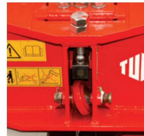
De Centermatic weegbok meet met één weegcel. De helling wordt in de computer gecorrigeerd.
