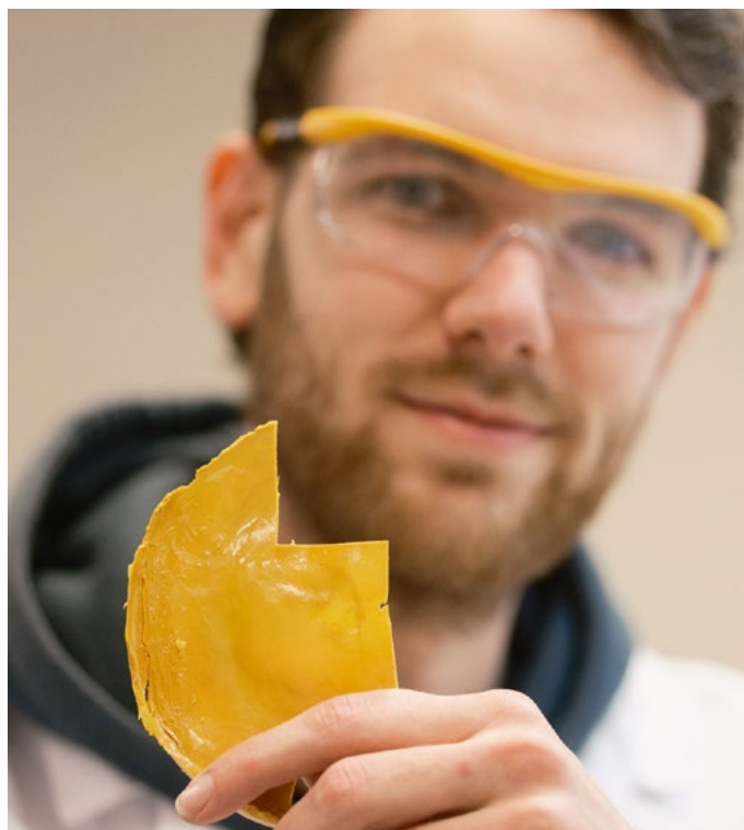
Sybren Schoustra met het zelfhelende plastic: de afgeknipte hoek ‘groeit’ weer aan het geheel vast.
