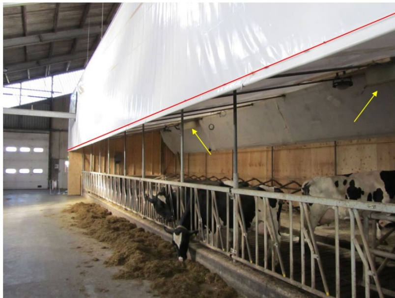
Figuur 3 Meetopstelling op de Dairy Campus in Leeuwarden. Het gordijn voor regulering van de luchtinlaat is omhoog. De rode lijn geeft de meetpunten voor de achtergrondconcentratie aan en de gele pijlen wijzen naar de ventilatoren waar ammoniakconcentratie in de uitgaande lucht wordt gemeten.
