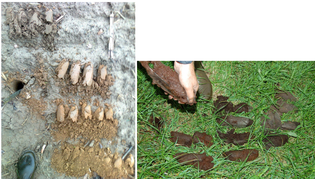
Figuur 4 Twee boorprofielen: links van een kalkrijke rivierkleigrond; rechts van een veengrond.
