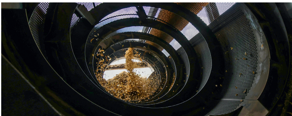
Een tot maiszeefmachine omgebouwde compostzeef wordt gebruikt om kuilmals te zeven
