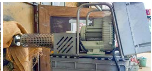
Toepassing met cropfog (links) en synofog (rechts). De cropfog kan een veel groter debiet bereiken. Daarom wordt bij zeer grote aardappelloodsen voor dit toestel gekozen. De cropfog werkt op methanol en kan daarom zonder stroom worden toegepast. Methanol heeft het voordeel dat er minder CO 2 vrijkomt bij verbranding in vergelijking met benzine, wat nefast voor de aardappelen kan zijn. De synofog wordt aangedreven door stroom en behaalt een meer beperkt debiet.
