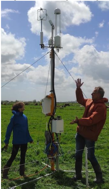
Figuur b1 – een eddy covariance mastje met bovenin (vlnr.) de wind-, H 2 O/CO 2 -, en CH 4 sensoren.
