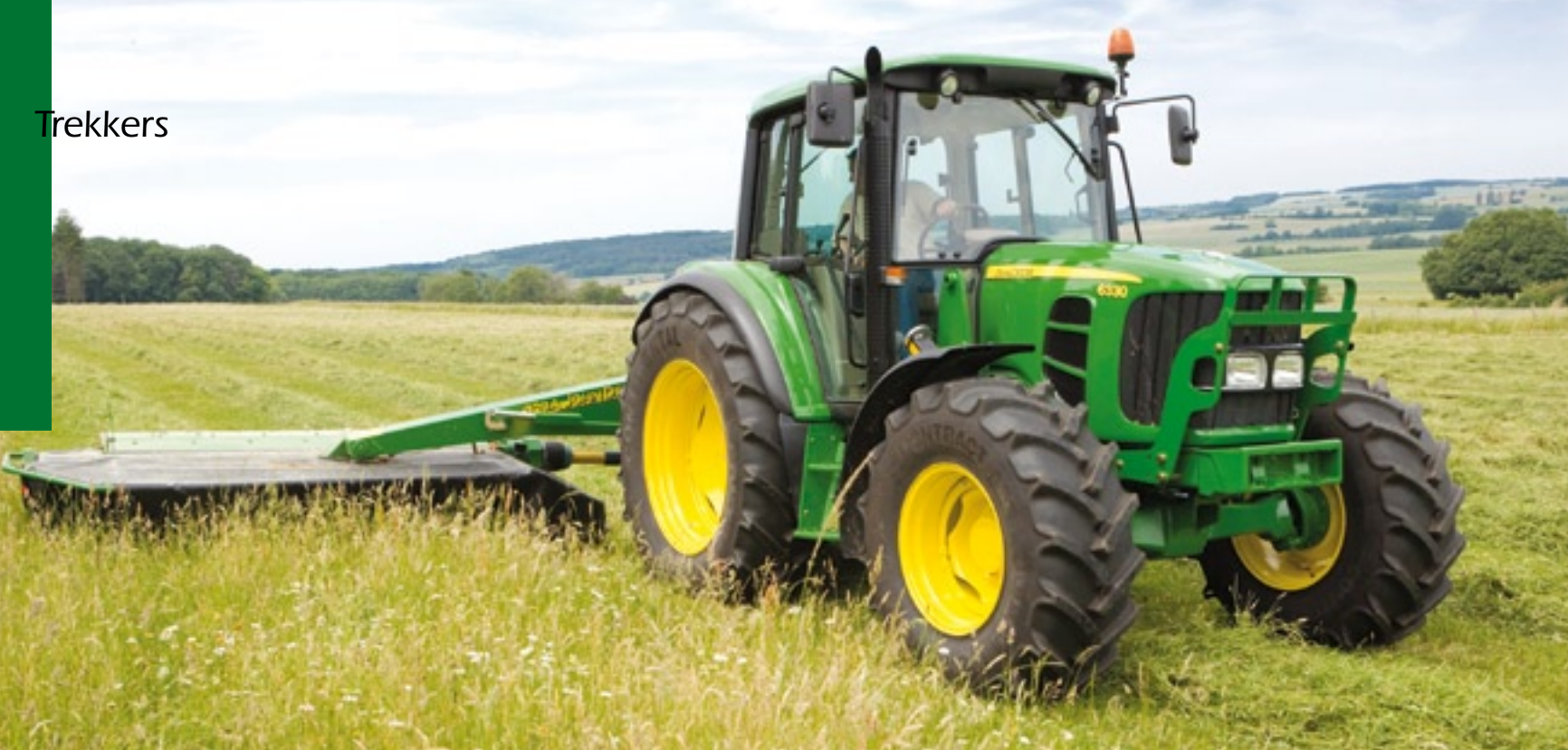
John Deere's eenvoudige 6330 is het op een na grootste model uit de 6030-serie met een viercilinder motor.
