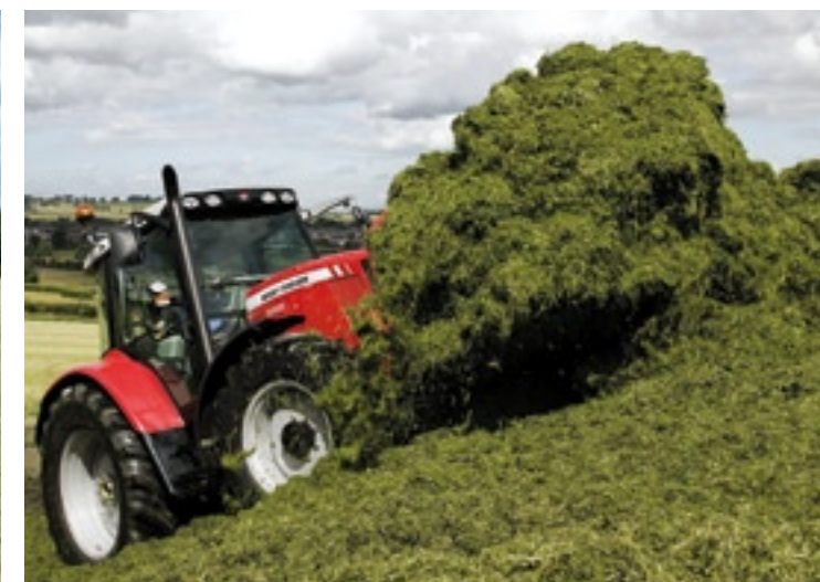
De Massey Ferguson 5480 is de sterkste trekker uit de 5400-serie. De trekker is voorzien van een viercilinder Sisu motor die 150 pk levert.
