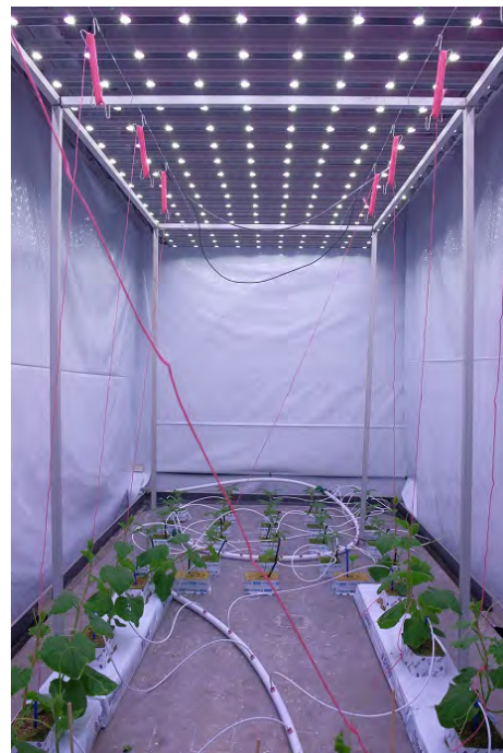
Figuur 5.1 Schematische weergave van de verdeling van de lichtbehandelingen over de tafels in het IDC LED (links) en een foto van de start van het experiment, met vooraan de tafel twee rijen komkommerplanten op een steenwolmat, en achteraan de losse jonge tomatenplanten in steenwolblokjes.
