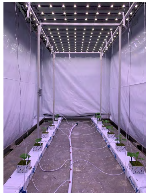
Figuur 6.1 Schematische weergave van de verdeling van de lichtbehandelingen over de tafels in het IDC LED (links) en een foto van de start van het experiment, met twee rijen komkommerplanten op steenwolmatten, links Qwerty en rechts Hi Power.
