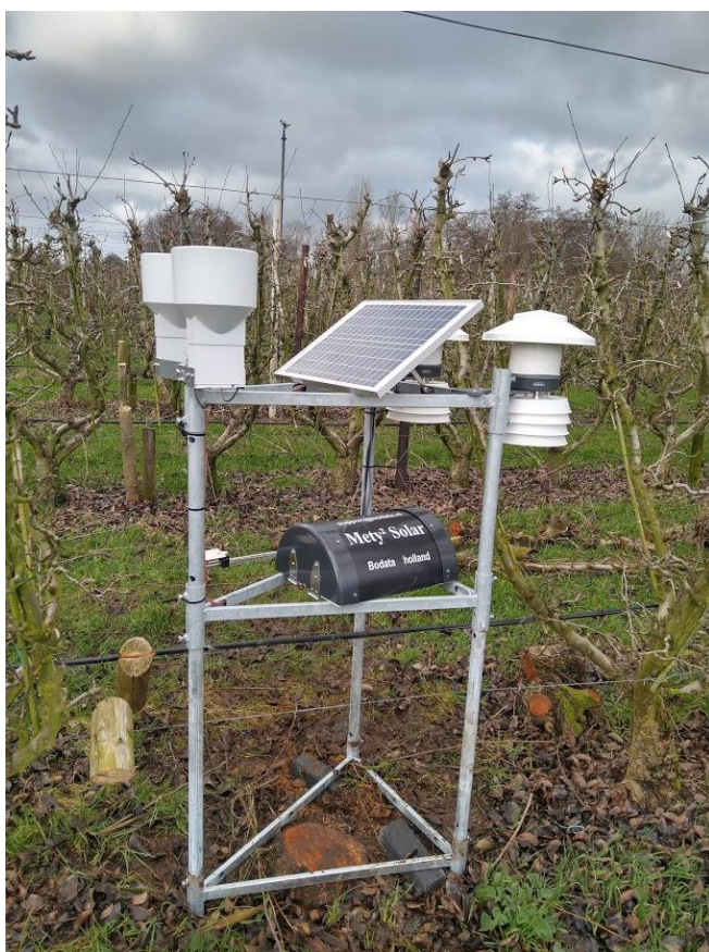
Foto 2 Het weerstation van Bodata dat onder meer neerslag, temperatuur en straling meet voor het simuleren met IRRY.
