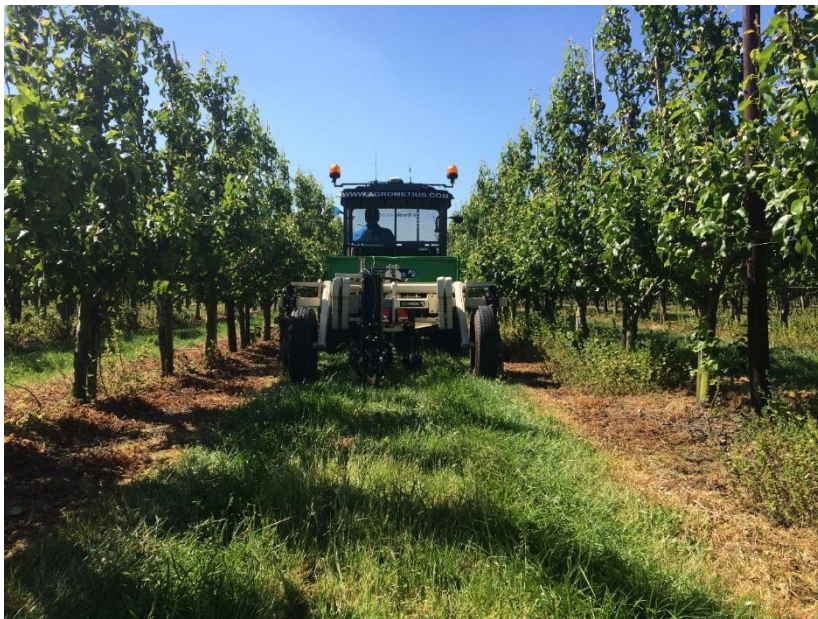
Foto 3 De Veris-bodemsan maakt een grasstrook-scan op het Testperceel te Geersdijk.
