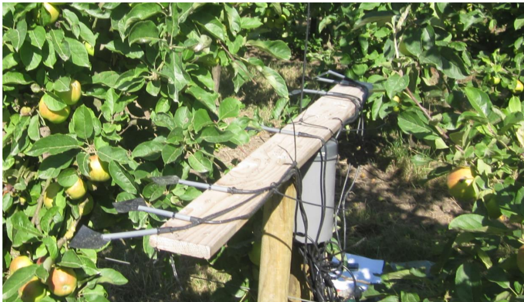
Foto 4 Plaatsensoren voor de meting van temperatuur in de Flipper-test
