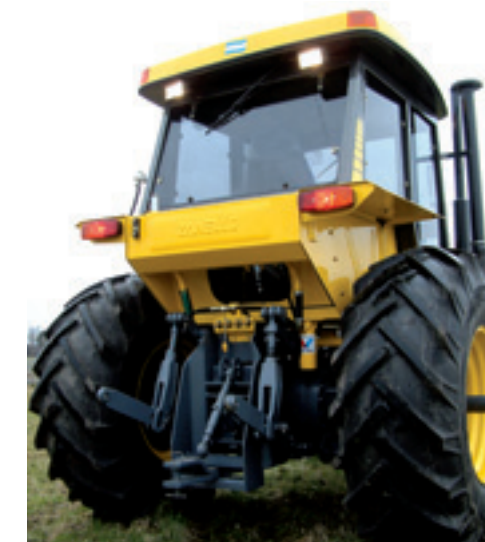
De standaard hef van de vierwiel-aangedreven Zanello 250A is eenvoudig en licht. Hij tilt 5.000 kg. Een elektronische Bosch-hef die hetzelfde heft, is leverbaar voor een meerprijs van 3.500 euro.
