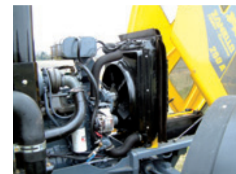
De kunststof motorkap klappt naar voren open. De Cummins-dieselmotor die er onder ligt, voldoet nog niet aan de Europese milieu-eisen. Er is echter ruimte genoeg voor een versie die dat wel doet.
