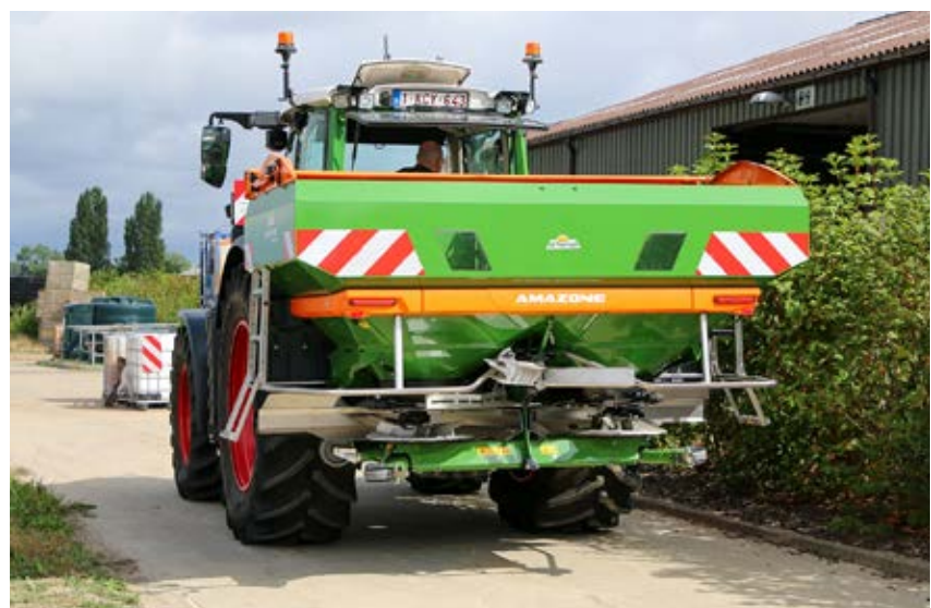
Deze precisiebemester is uitgerust met een weegstelsel en gps-technologie.
