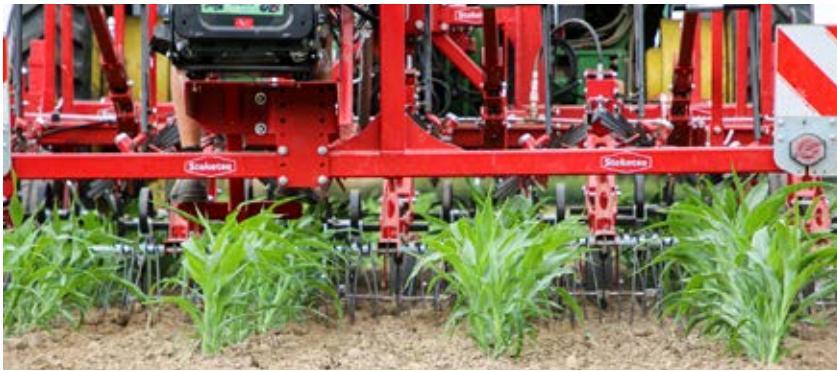
Deze cameragestuurde schoffel ziet de rijen. Het is dus niet noodzakelijk dat ze gezaaid zijn met RTK-gps.
