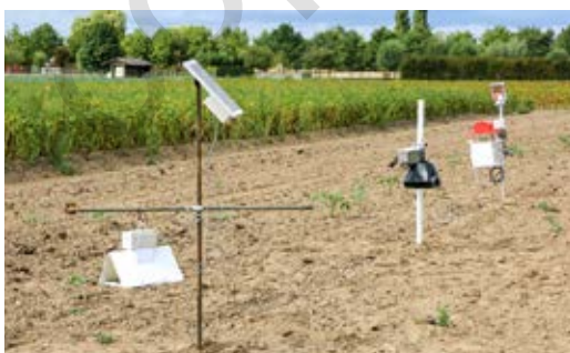
Slimme vallen werken met een lijmplaat, lokstof, camera, batterij en pv-paneel.
