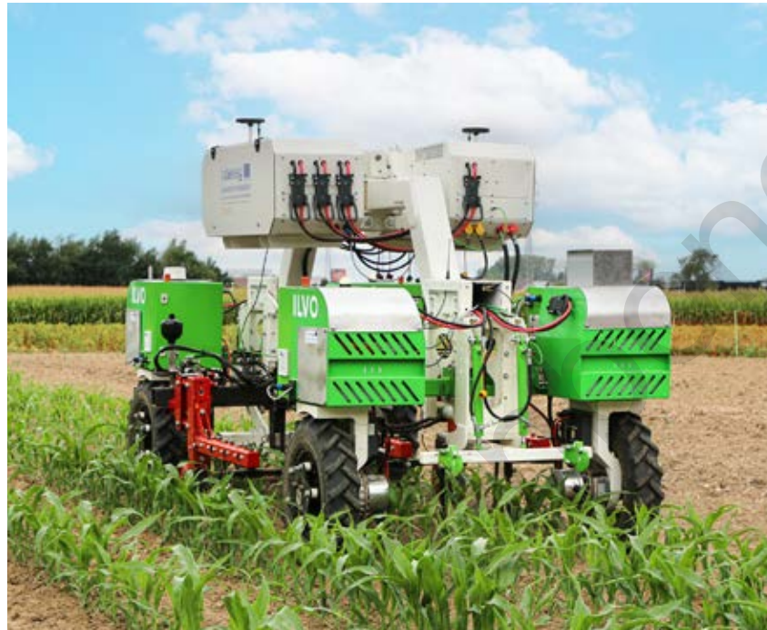
De autonome veldrobot Cimat aan het werk tussen de mais.
