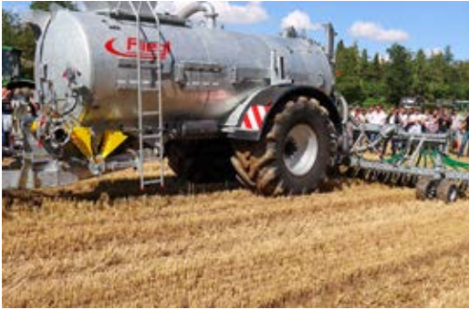
Op bouwland zorgt de Fliegl-schijveninjecteur voor een goede mestafdekking en weinig stikstofemissie.
