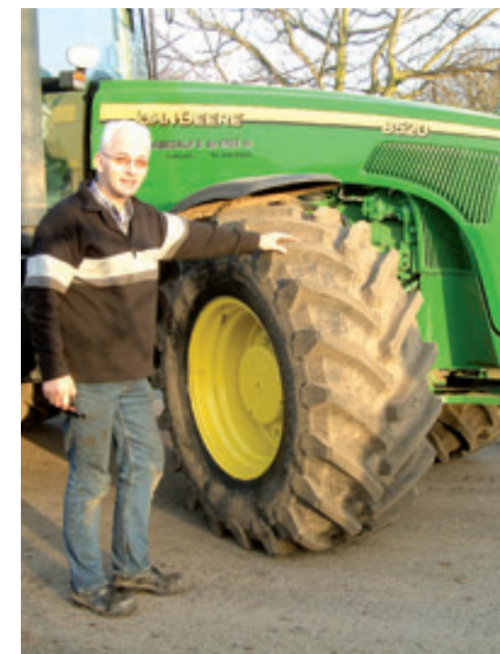
Ben de Vree voor de trekker: "Door de grote wieluitslag van de grote voorbanden is met de John Deere 8520 een korte draaicirkel mogelijk."
