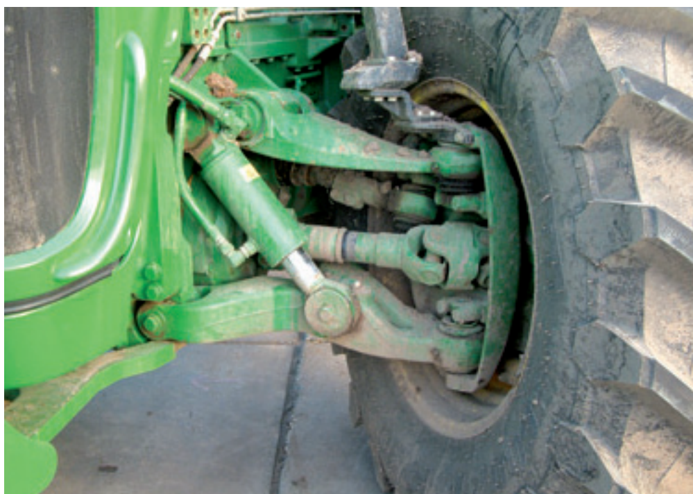
De onafhankelijke wielophanging met parallelvoering houdt de banden recht op het maaiveld en zorgt voor perfect rijgedrag.
