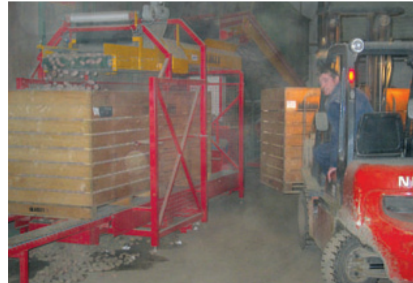
Wisselen van de kisten lukt bij de Logimax met één heftruck. Ben je niet op tijd, dan stopt de machine. Durk Hilarides hier wachtend met een lege kist. Na plaatsing kan hij een volle kist meenemen.
