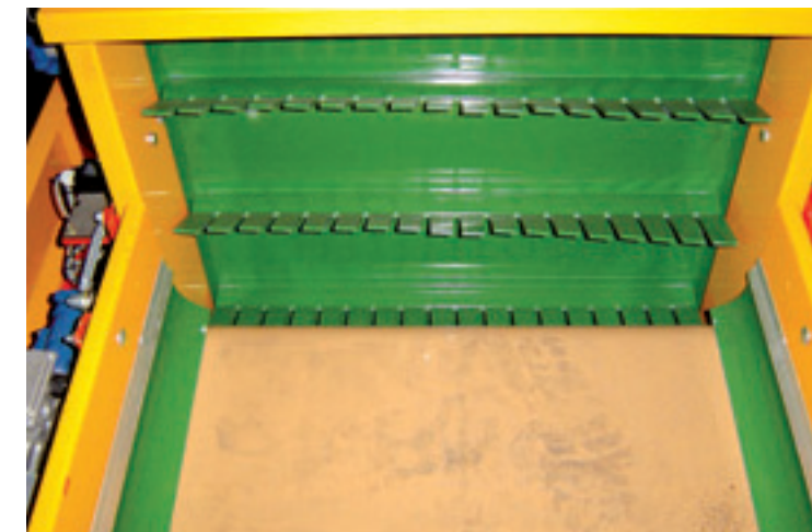
De EFF II kistenvuller is groter en sneller dan de Logimax. Ander verschil is het vulsysteem. De EFF heeft een verticale vulband met PVC-lepels waar de Logimax een vlakke vulband heeft.
