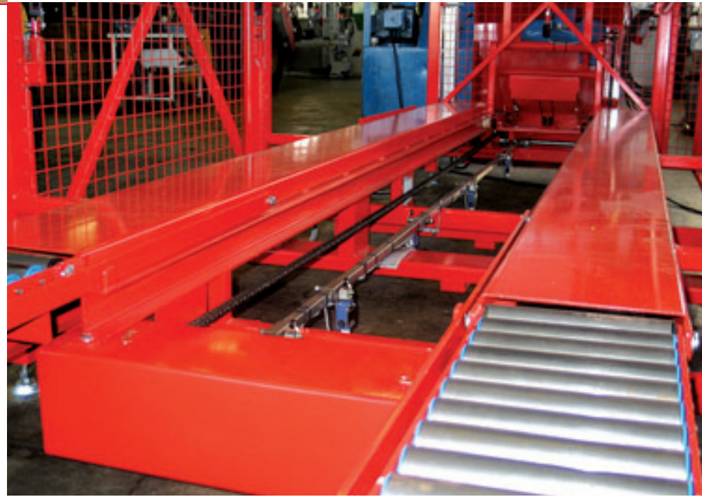
Volle kisten schuift de Climax kistenvuller op de rollenbaan. In het midden zijn de sensoren te zien die aan de elektronica doorgeven waar de kisten staan.
