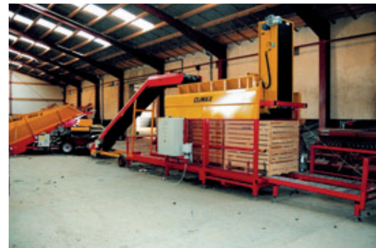
De EFF II kistenvuller is groter en sneller dan de Logimax. Ander verschil is het vulsysteem. De EFF heeft een verticale vulband met PVC-lepels waar de Logimax een vlakke vulband heeft.
