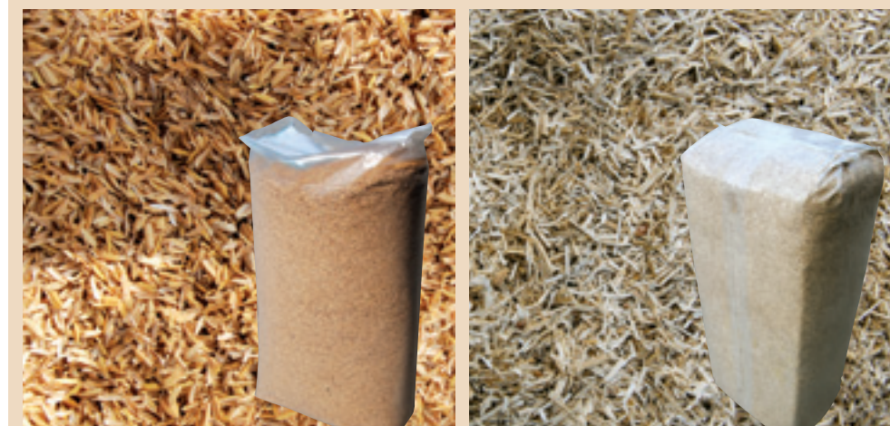
Michari, rijstekaf uit Italië (links), wordt geleverd in zakken van 12 kg. Het is licht en veerkrachtig, maar neemt weinig vocht op. Fijn lemen (rechts) neemt erg goed vocht op en is goedkoop. Het wordt geleverd in zakken van 22 kg, maar is lastig verkrijgbaar.
