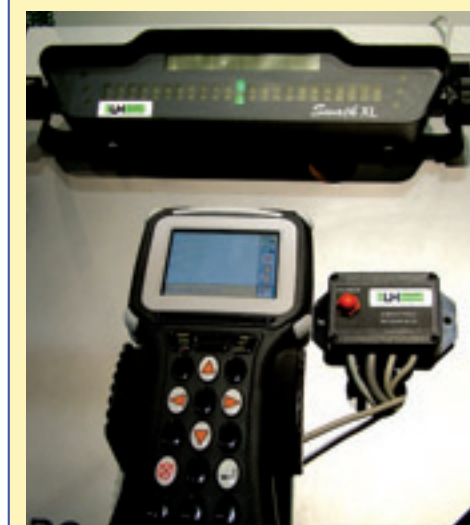
Met Smartpad II koop je een beeldscherm en opslagmogelijkheid bij het al bestaande Swathmaster XL rechtrijstelsysteem.
