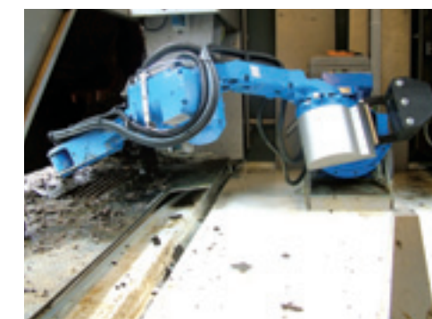
De beide melkboxen worden bediend door een industriële robotarm.
