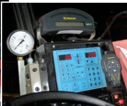
De Centerline is overal te plaatsen. Frits van de Vendel heeft de monitor gemonteerd op de boordcomputer van een zelfrijdende spuitmachine. De draadloze afstandsbediening zit er met klittenband aan vast.
