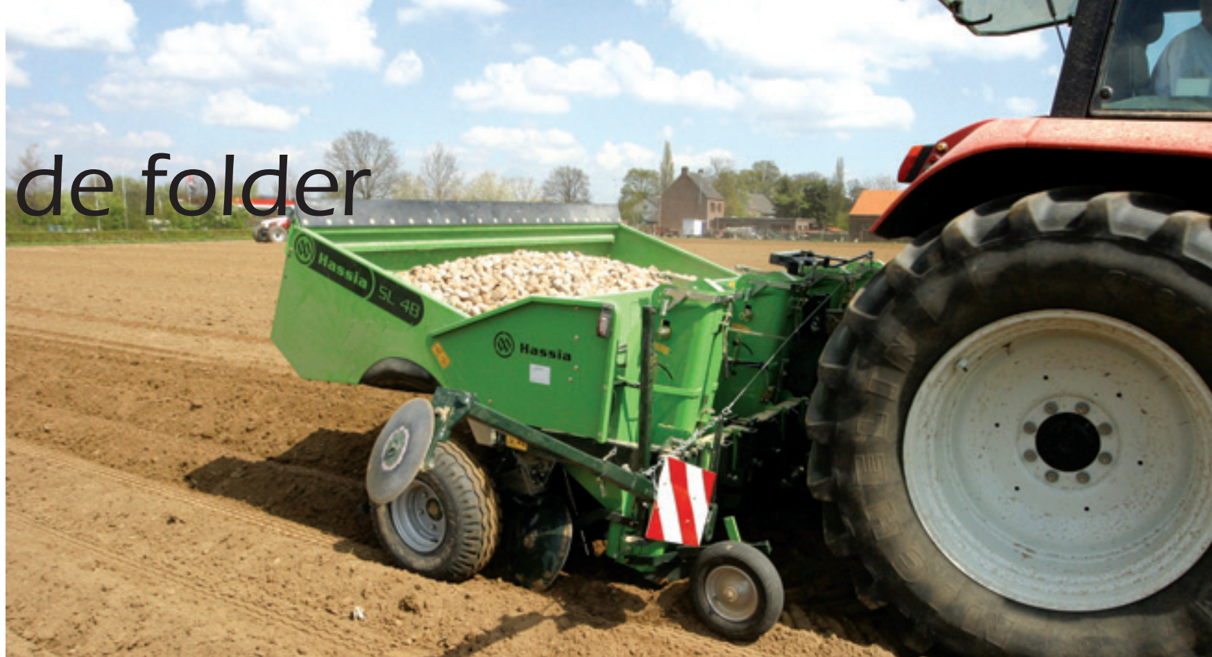
Het maximum hefvermogen uit de folder is niet wat de trekker in de praktijk kan tillen. Bij bijvoorbeeld een zware ploeg of volle pootmachine kom je daar snel achter. Van belang is het gewicht wat de driepuntshefinrichting vanuit het laagste stand kan tillen.
